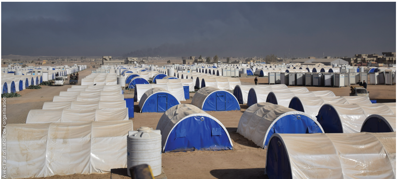
Des tentes aux normes gouvernementales de 6 m x 4 m ont été installées en blocs de 20 tentes chacun. Peu d'espace était disponible pour un agrandissement, mais une fois les familles installées, le sol des tentes a été amélioré et l'électricité a été installée. Les partenaires ont ensuite pu construire des installations de services dans des blocs prévus à cet effet conformément au plan du site.
