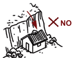
No construir en barrancos ni zonas de derrumbe.
